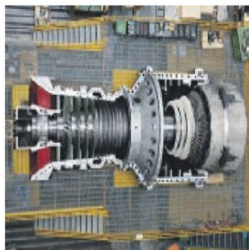
AI TEST La turbina a gas AE94.3A
