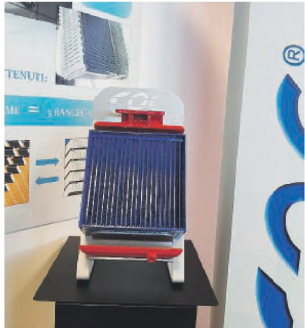
LECCE Un radiatore per le trasmissioni dell'elicottero AW139
